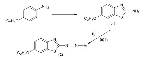
(a) NaNO<sub>2</sub> / HCl, 0°C, (b) ArH / dil. NaOH, 0°– 5°C,
